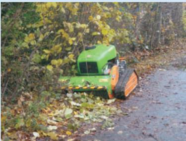
Mit dem Mulchroboter wird der Bewuchs am Wegesrand zerkleinert und bleibt ebenfalls als Dünger liegen.
