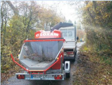
Dahinter kommt der Schredder zum Einsatz, mit dem die Äste zerkleinert und als Dünger rechts und links am Weg ausgeblasen werden.
